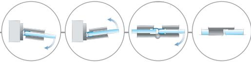
FLINTER entfaltet seine ganze Kraft vor allem in Badewannen- und Falttüranlagen. Die Federtechnik sorgt für eine feste Einrastfunktion des Türflügels. Je nach Größe und Gewicht des Türflügels und der Art des Türanschlages haben Sie die Wahl zwischen null und drei Federn. Für Falttüranlagen empfehlen die Experten von Pauli + Sohn die Kombination mit FLAMEA+ als Wandbeschlag. Damit lässt sich der Türflügel zum Reinigen optimal nach außen öffnen. Fehlbedienung ausgeschlossen!
