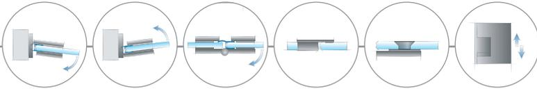
Die Serie NIVELLO<sup>+</sup> wurde speziell für ein barrierefreies Duscherlebnis entwickelt. Denn schwellenlos begehbare und großzügig dimensionierte Duschen stehen bei Bauherren und Architekten weit oben auf der Wunschliste für ein neues Bad. Das Duschtürband hebt die Tür im Öffnungsvorgang leicht an und ist im Senkvorgang selbstschließend. Zudem bieten die flächenbündigen Verschraubungen einen hohen Reinigungskomfort.
